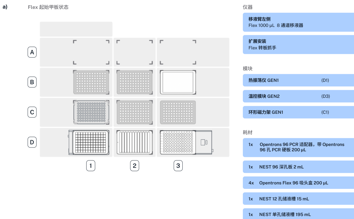
图 2. 三种常见应用的平台甲板布局和移液器配置示例 (a) 核酸提取，(b-c) 请看第 4 页
